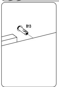
Надвиньте крышку 11 на винты В13 задней стенки Зафиксируйте крышку конусными винтами В14 Установите заглушку кабель—канала в крышку 11
